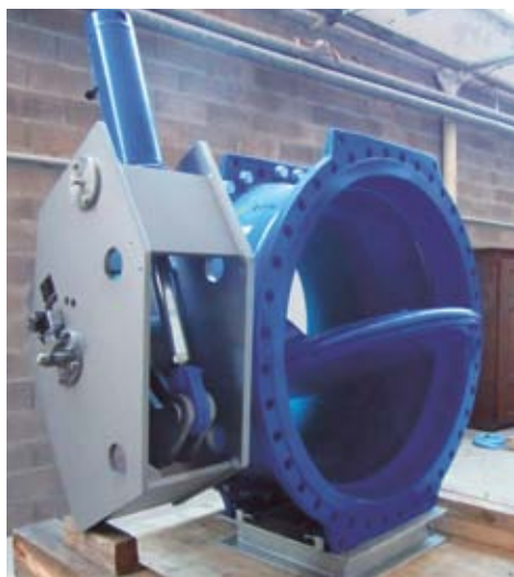
Die Absperrklappe der Druckleitung.
