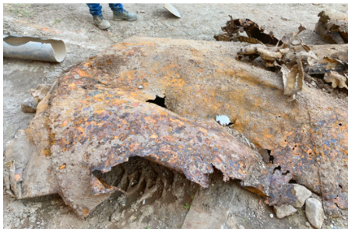
Das korrodierte Eisenrohr wurde durch ein modernes GFK-Rohr ersetzt.
