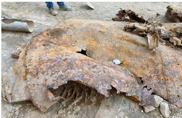
La vieille conduite rouillée a été remplacée par un tuyau en fibre de verre.
